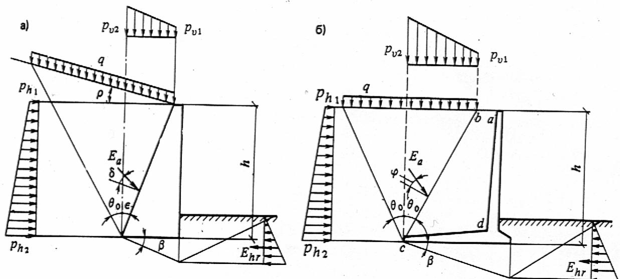
Черт. 1. Расчетные схемы подпорных стен
