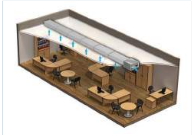
Вариант применения вентилятора ВКПФИ в офисном помещении
