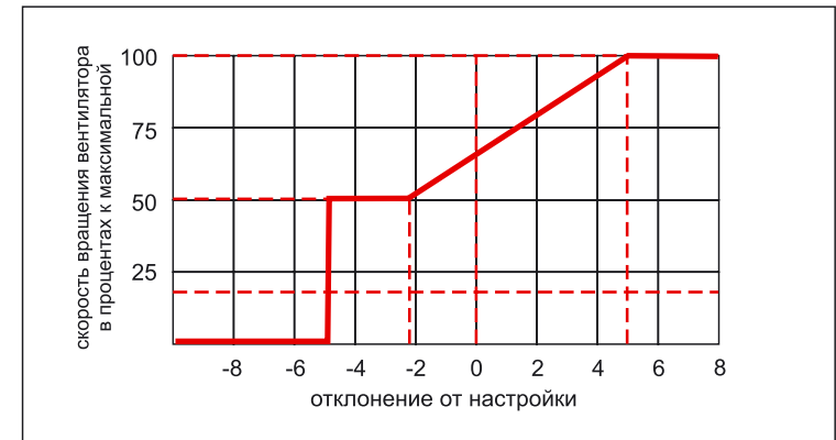
Рабочая характеристика HPC (LAC)
