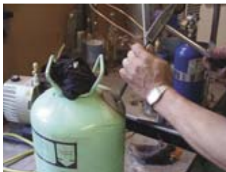
Только керном. Сверлить нельзя, иначе попадет стружка
