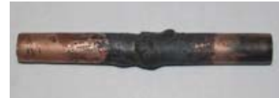
Перегретое соединение труб
